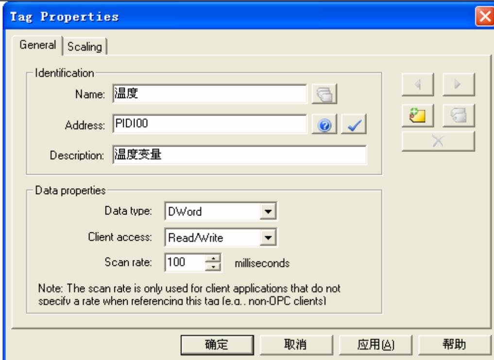
注意：设置 Address 时，必须确保填写的内容是硬件设备内部允许访问的地址，在你填好之后，可以单击“对号”按钮进行测试或帮助。
