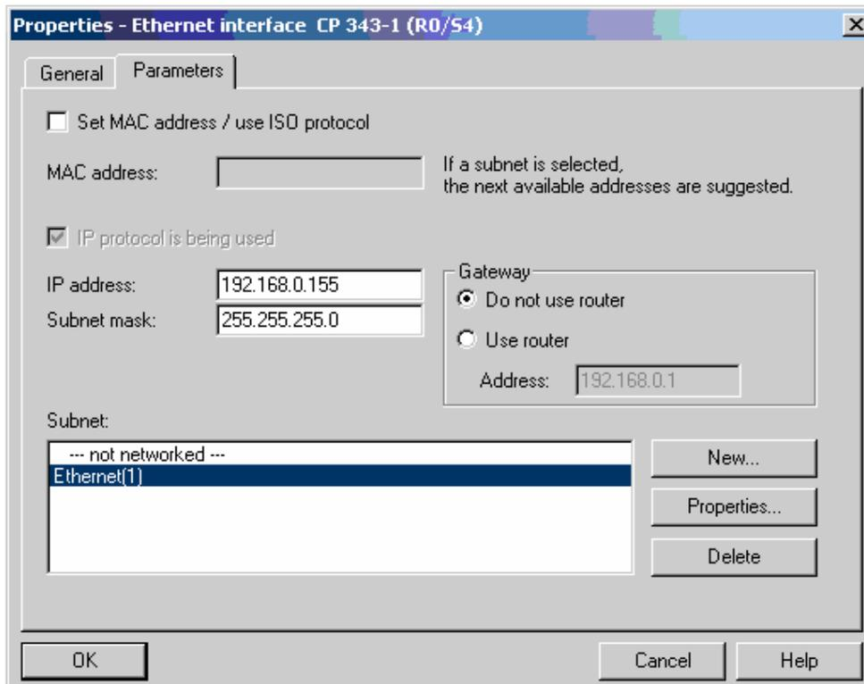
如上图所示，在“IP address”以及“Subnet mask”中分别设置通信模块的 IP 地址和子网掩码。注意：这里设置的通信模块的 IP 地址等参数应该和 KEPServerEX 中新建设备的 ID 等参数一致。
