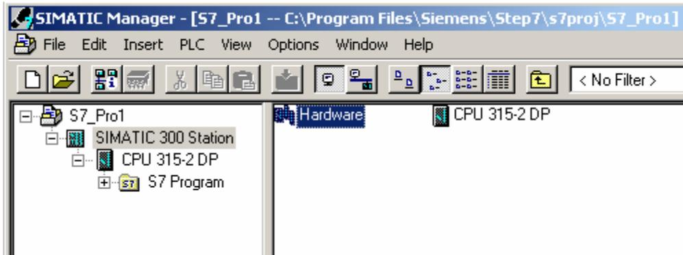
2. 在打开的硬件组态界面中进行相应组态，在机架“Rack”中插入需要的模块，为确保 Siemens TCP/IP 以太网驱动和 PLC 的正常通信，至少需要插入一个以太网通信模块（CP343）。
