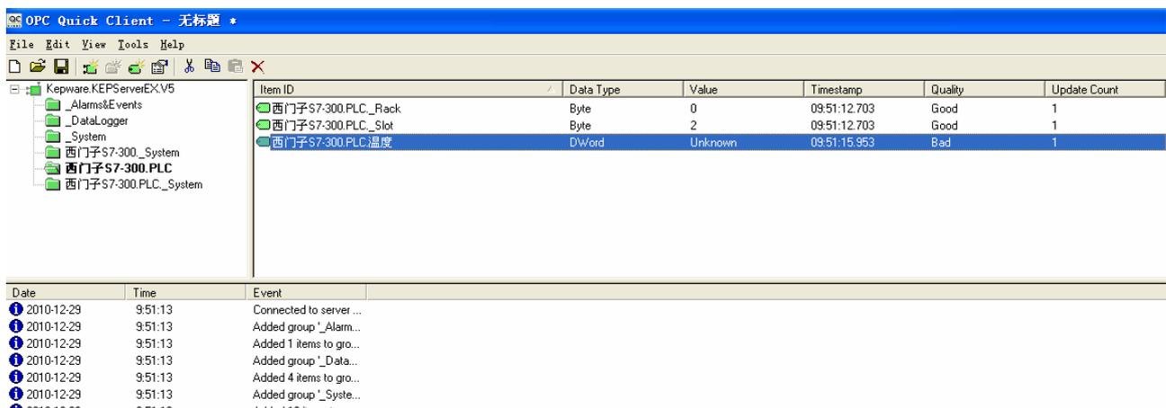
当上图中的“Quality”变为“Good”时，表明 OPC server 已经和西门子 S7-300PLC 正确连接，且从上图中的“Value”中获取该温度值。
